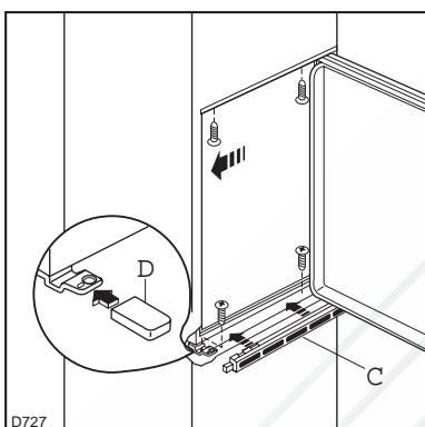
**4.** Приблизить прибор к боковине мебели, противоположной петлям. Закрепить прибор имеющимися 4 винтами. Установить вентиляционную решётку (С) и накладку петли (D), защёлкнув их.
