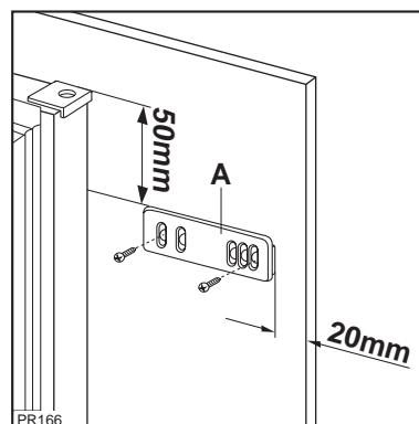
**7.** Приложите направляющую (А) на внутреннюю сторону двери шкафа, сверху и снизу, как показано на рисунке, и отметьте положение крайних отверстий. Подготовив отверстия, установите направляющую при помощи входящих в комплект винтов.
